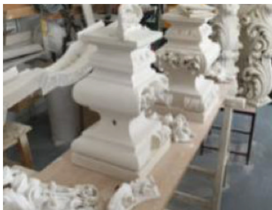
Aplicación de diversas capas de aparejo
